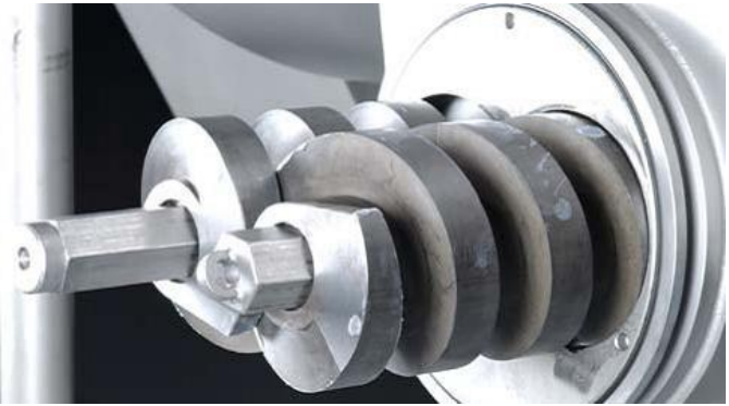
Рисунок 4. Вовчок-мішалка CFS ComboGrind: а) – загальний вигляд; б) – місильний робочий орган; в) – робочі шнеки вовчка
