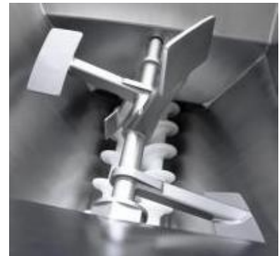
Рисунок 6. Вовчок-мішалка Inotec Grinder W 235: а) – загальний вигляд; б) – різальний комплект; в) – змішувальний вал та шнеки для подачі сировини
