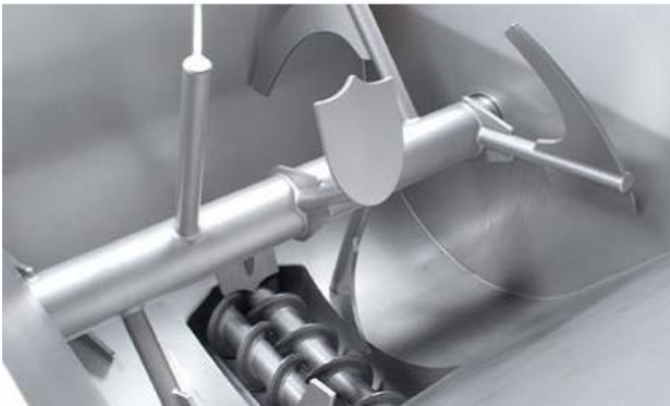
Рисунок 4. Вовчок-мішалка CFS ComboGrind: а) – загальний вигляд; б) – місильний робочий орган; в) – робочі шнеки вовчка
