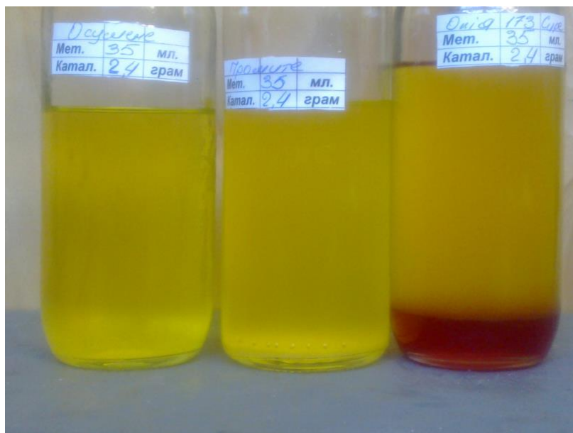
Рисунок 7. Дослідні зразки дизельного біопалива відпрацьованих олій після промивання та сушіння
