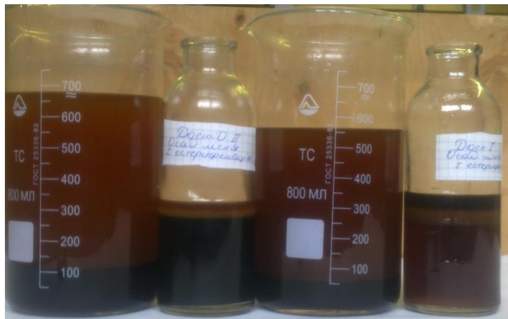
Рисунок 5. Дослідні ВО зразки після процесу естерифікації
