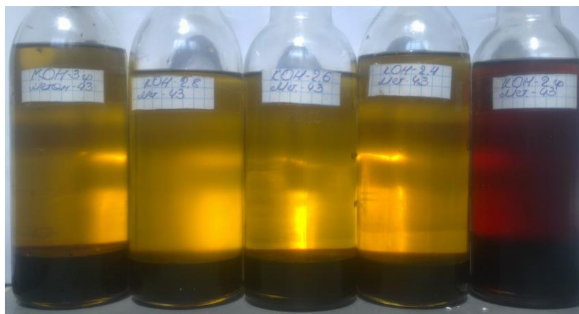
Рисунок 6. Дослідні зразки після процесу переестерифікації
