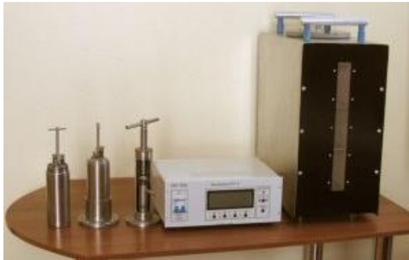
Рисунок 6. Інформаційно-вимірювальна калориметрична система КТС
