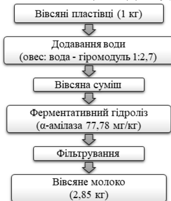
Рисунок 2. Блок-схема приготування вівсяного молока
