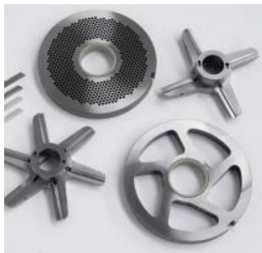
Рисунок 6. Вовчок-мішалка Inotec Grinder W 235: а) – загальний вигляд; б) – різальний комплект; в) – змішувальний вал та шнеки для подачі сировини
